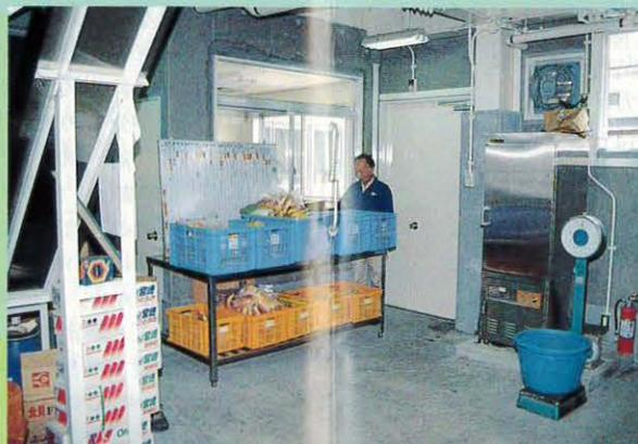
食料倉庫の内部です。ここで飼料を分配します。右手の四角い機械は蒸し器で、サツマイモや卵を蒸します。
