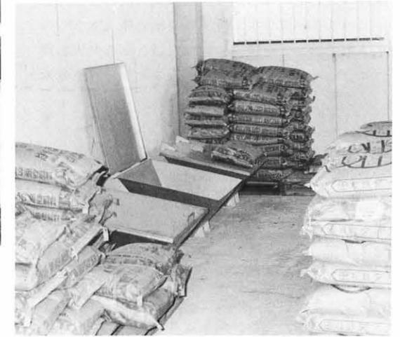
2階の倉庫には大型のハイザーが3基設置してあり、階下の給配室で必要量を取り出すようになっています。
